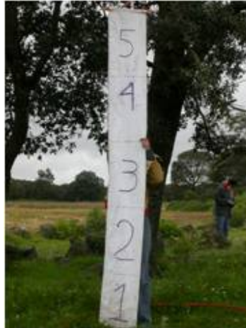
Figura 3. Manta de 2.5 m de alto x 0.5 m de ancho dividida en cinco partes de 0.5 x 0.5 m cada una utilizada para medir la estructura vertical de la vegetación alrededor del tronco de cada árbol.
