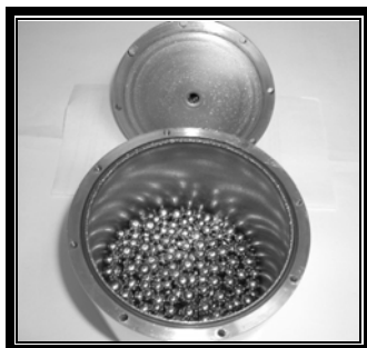
Figura 3.1. Molino horizontal de bolas.
