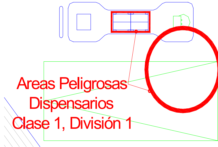
Figura 2.20 Identificación de Áreas Peligrosas en Dispensarios
