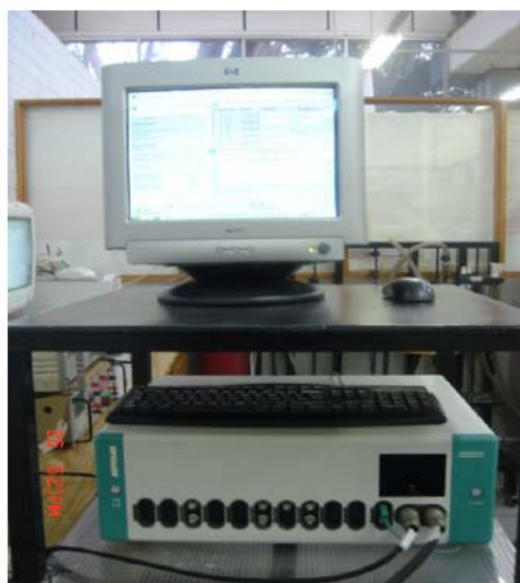
Figura III.2 AUTOLAB acoplado al equipo de computo para la obtención de datos experimentales.
