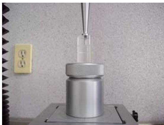
Figura 12. Colocación de la muestra para prueba de adhesividad
