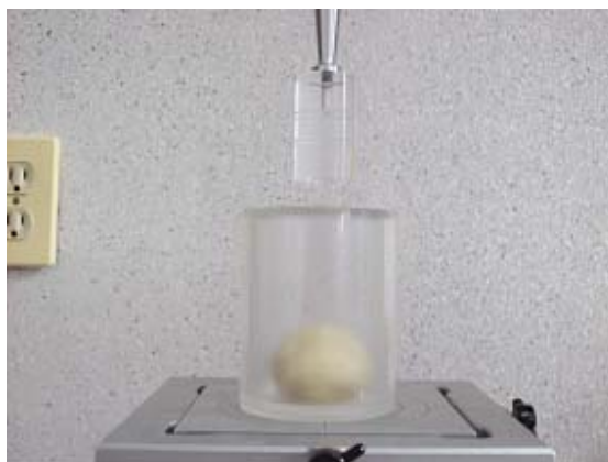
Figura 15. Colocación de la muestra para análisis de perfil de textura en masas
