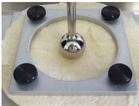
Figura 19. Primer ciclo de elongación en la prueba de análisis de perfil de textura de tortillas
