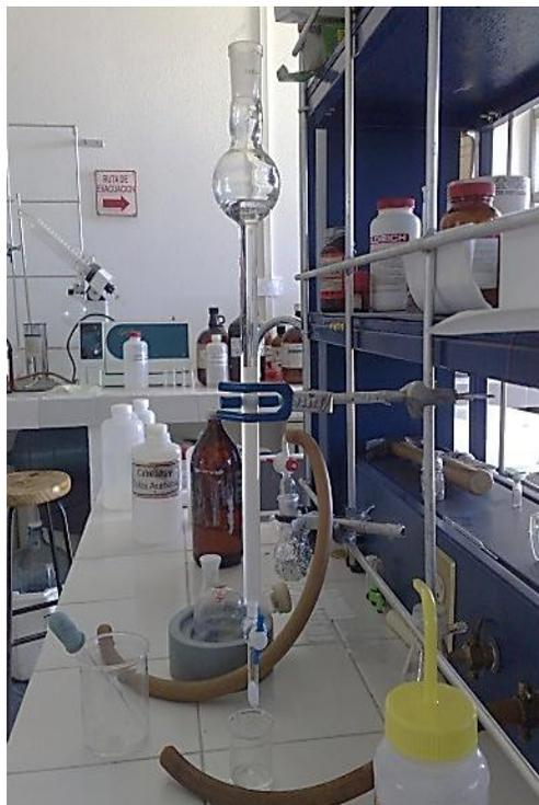
Figura 27 Purificación del 1,4FBAC mediante cromatografía en columna
