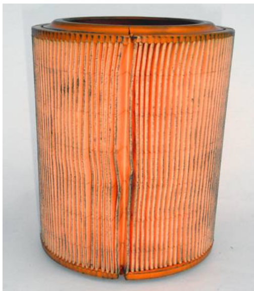
Figura 33. Filtro de aire
