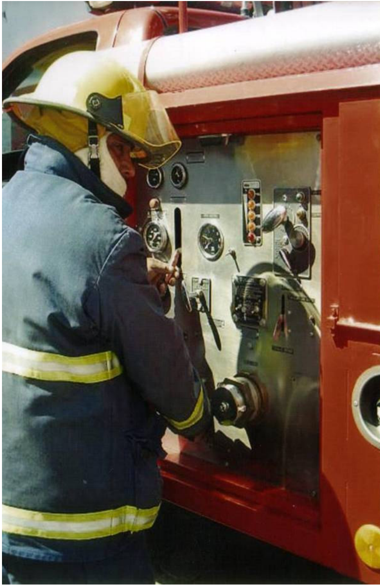
15. Tablero de operación para controlar la presión de agua.
