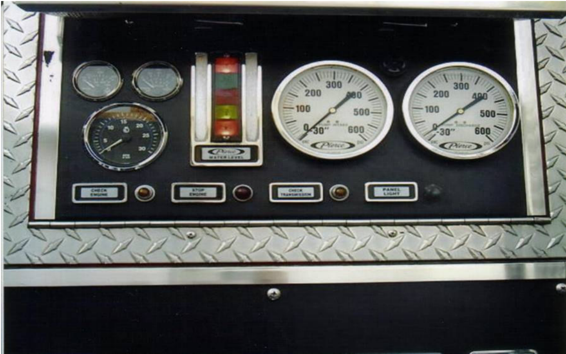
FOTOGRAFIA 9: líneas vivas de 1 ½", 2 – 21/2 y 2 succionadores. Cada salida tiene manómetro de descarga y muestra a cuantas libras entra el agua.
