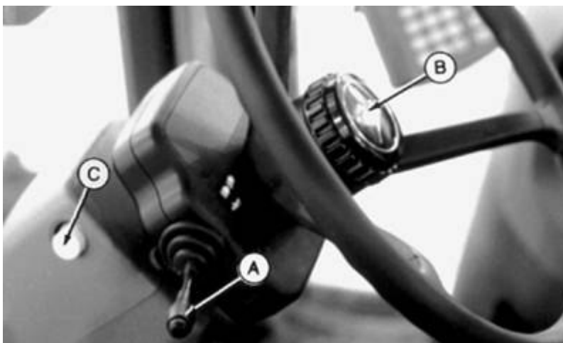
Figura 2. Control de luces
