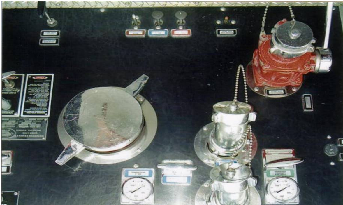
FOTOGRAFIA 10: líneas vivas de 1 ½", 2 – 21/2 y 2 succionadores. Cada salida tiene manómetro de descarga y muestra a cuantas libras entra el agua.
