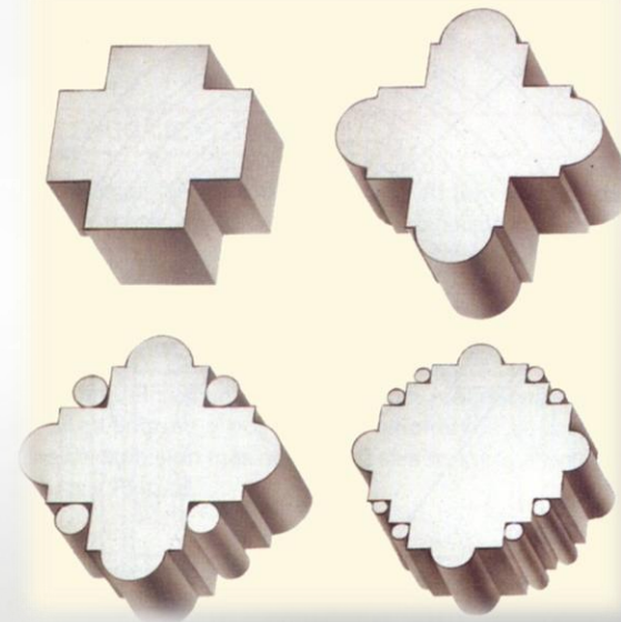
EVOLUCION DEL PILAR CRUCIFORME EN EL ROMANICO
