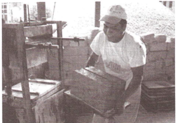
Imagen 4. Elaboración de block con material reciclado.
