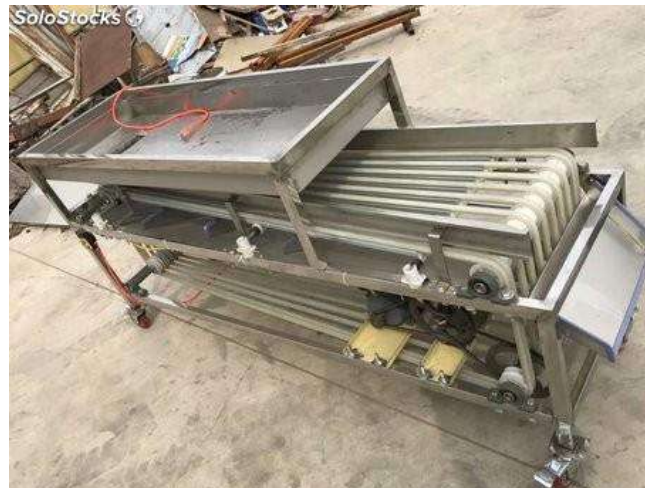
Figura 1. Máquina clasificadora de frutas.
