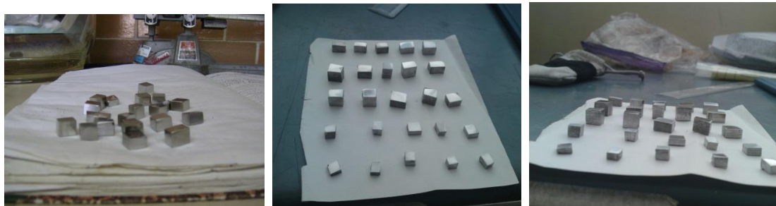
Figura 3. Probetas de Acero Inoxidable 304L con dos caras a lija 600, para simular el acabado superficial de los componentes internos del reactor BWR.
