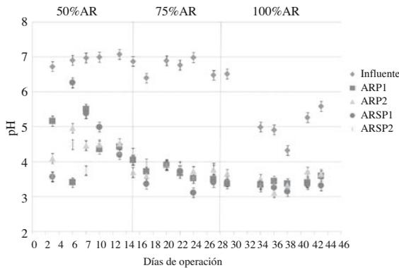
**Figura 3. Valores de pH del influente y efluentes de los reactores dosificados con agua residual, AR, de la empresa minera (donde: ARP1 y ARP2 son los reactores con planta y ARSP1 y ARSP2 son los reactores sin planta)**
