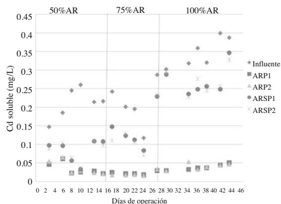
**Figura 5. Concentraciones de  $Cd_{soluble}$  en el influente y efluentes de los reactores dosificados con agua residual de la empresa minera (donde: ARP1 y ARP2 son los reactores con planta y ARSP1 y ARSP2 son los reactores sin planta)**
