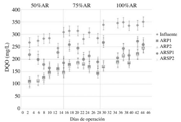
**Figura 4. Valores de DQO<sub>soluble</sub> medida en el influente y efluentes de los reactores dosificados con agua residual de la empresa minera (donde: ARP1 y ARP2 son los reactores con planta y ARSP1 y ARSP2 son los reactores sin planta)**
