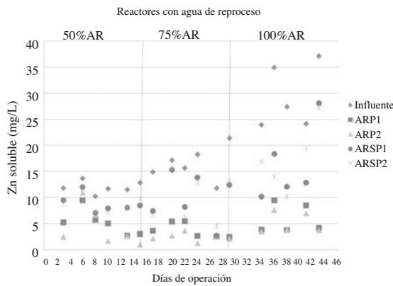
**Figura 6.** Concentraciones de Zn<sub>soluble</sub> en el influente y efluentes de los reactores dosificados con agua residual de la empresa minera (donde: ARP1 y ARP2 son los reactores con planta y ARSP1 y ARSP2 son los reactores sin planta)
