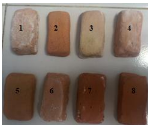
Figura 4. Compósitos cerámicos hechos con material de escombrera y arcillas pesadas.
