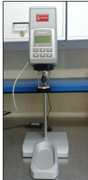
Figura 3. El análisis de la reología de las soluciones de quitosán con, y sin nanopartículas, se realizó con un reómetro modelo Rheolab QC, marca Anton Paar.
