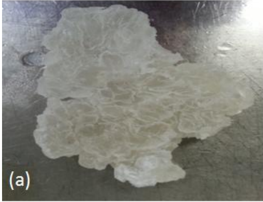
Figura 2. (a) Almidón ceroso termoplástico (ATP c ) y (b) almidón fosfatado termoplástico (ATP i ).
