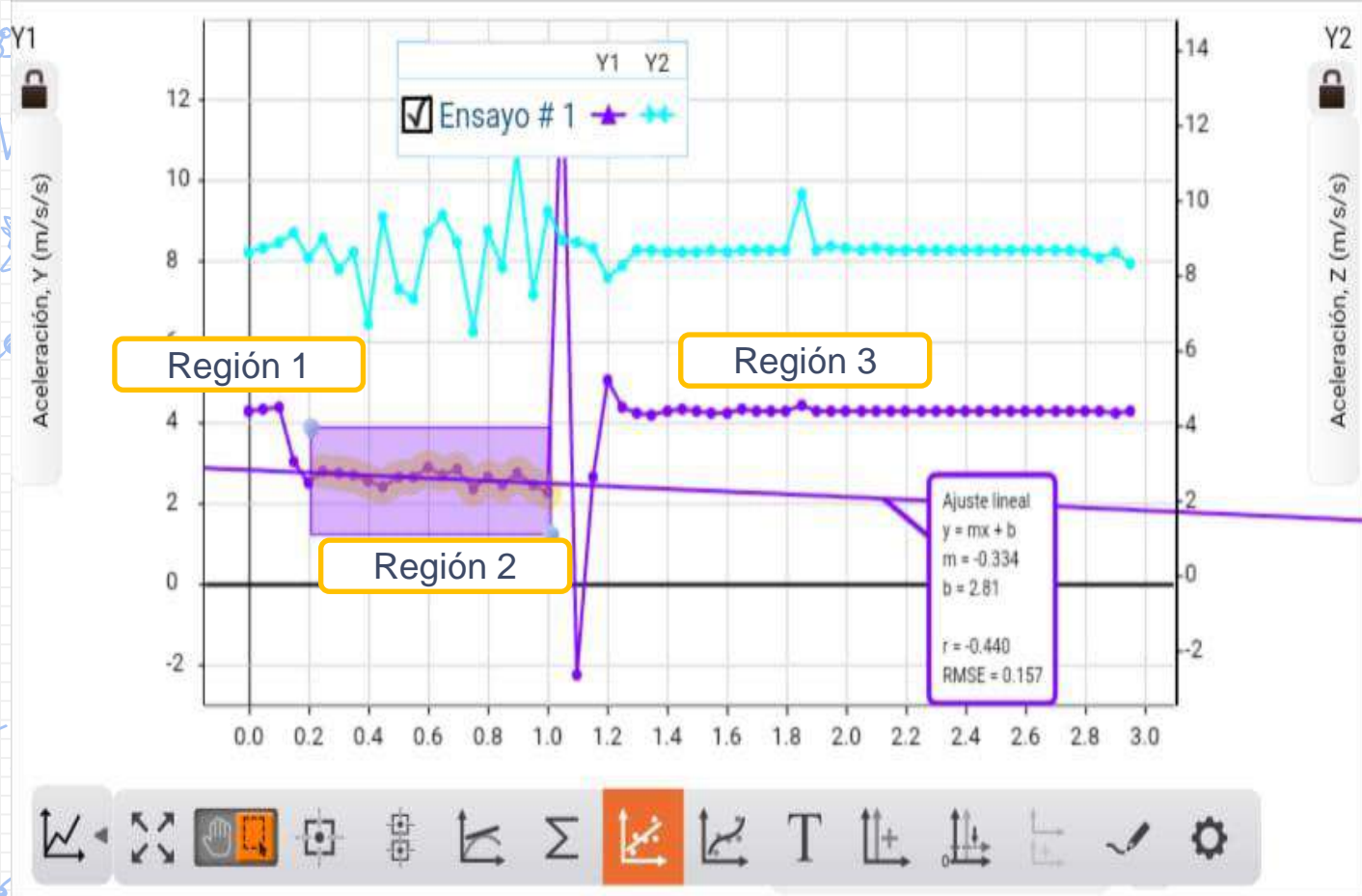
Fig. 6 La curva color turquesa representa el cambio de la aceleración en dirección z. La curva color violeta representa la aceleración en el eje y, cuya dirección corresponde a la dirección de movimiento del bloque(celular).
