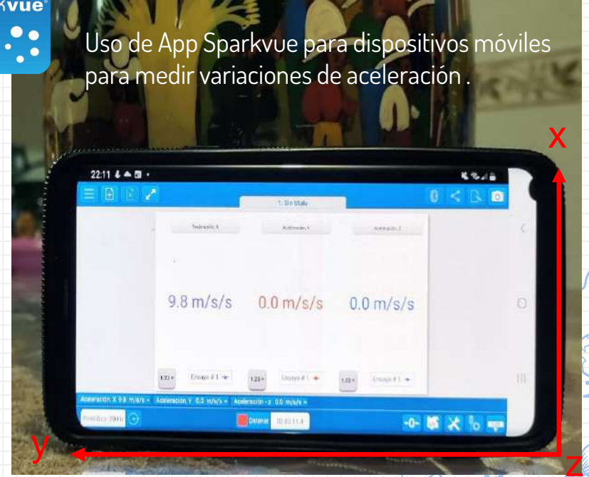
Fig. 2 Celular en reposo sobre la mesa (vista frontal). En la dirección vertical actúa la aceleración de la gravedad indicando 9.8 m/s 2 , mientras las demás direcciones y, z, toman valores promedio nulos.
