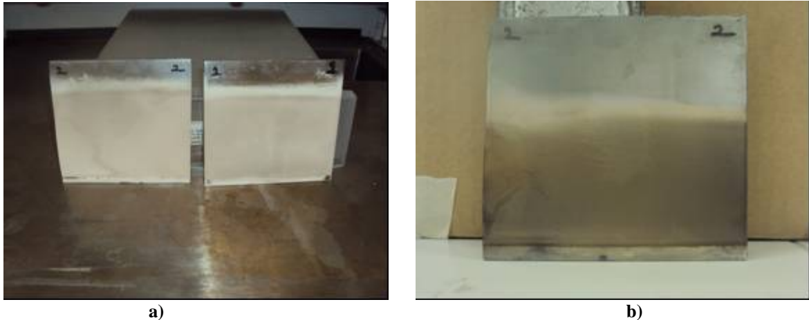
Figura 2 Fotografías de una placa de A304 después de llevar a cabo una macroelectrólisis de 210 minutos donde se aplica un potencial de celda de: a) 0.85 V y b) 0.9 V y empleando una velocidad lineal de flujo de 14 Lmin -1
