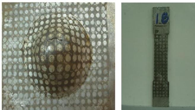
**Figura 10:** Ejemplo de probetas que han sido sometidas a ensayos de embutido y de tracción a fin de obtener el diagrama límite de conformado (DCL).
