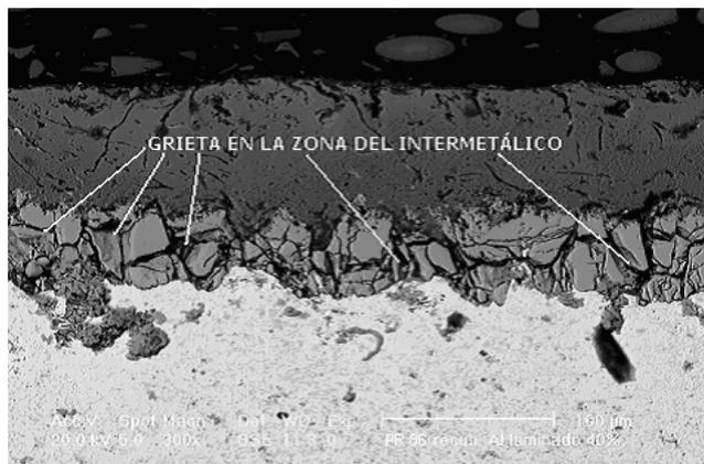
**Figura 8:** Micrografía de acero 1018 recubierto mediante AIC y posteriormente laminado (40%) a 300°C, mostrando la presencia de grietas que se presentan de modo predominante en la zona del intermetálico, y poros, sobre todo en la superficie. BSE 300X.
