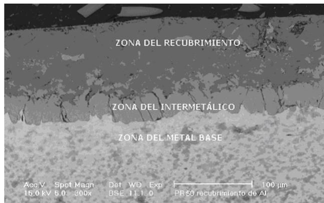
**Figura 2:** Micrografía de la sección transversal de la probeta de acero AISI 1018 aluminizada por inmersión en caliente. El espesor, poco mayor a 100 µm, presenta las zonas típicas de este tipo de recubrimientos: una zona externa rica en Al, una zona aledaña al sustrato con presencia de intermetálicos FeAl y la evidencia de grietas multidireccionales y la presencia del sustrato. BSE 300X
