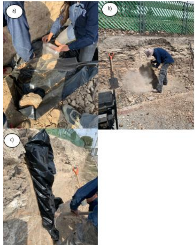
Figura 9. Fotografías del procedimiento para la recolección de monolito de suelo en la Unidad Profesional Multidisciplinaria “Miguel Hidalgo y Costilla”, donde: a) recolección de muestras de mano (las muestras fueron etiquetadas individualmente por número de horizonte), b) corte del perfil de suelo con ayuda de una esmeriladora angular, c) recubrimiento y extracción del perfil de suelo con ayuda de la caja de muestra.
