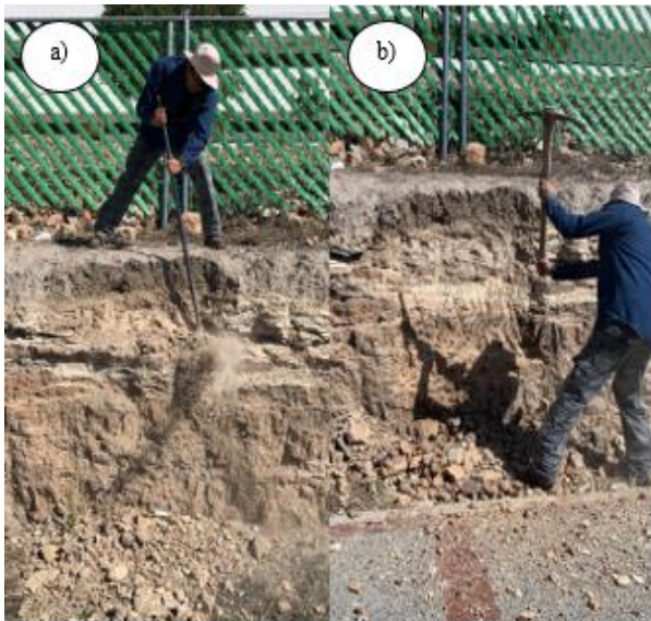
Figura 7. Fotografías del procedimiento para la recolección de monolito de suelo en la Unidad Profesional Multidisciplinaria “Miguel Hidalgo y Costilla”, donde: a) apertura de la calicata con barreta de acero, b) alisado de calicata con pico.
