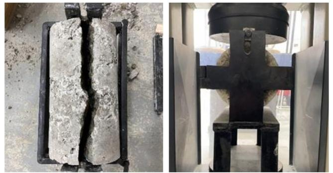
**Figura 3.2:** Ensayo de tracción indirecta
