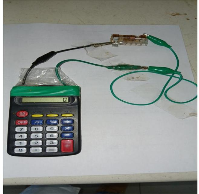
**Figura 11.** Fotografía de la calculadora encendida gracias al prototipo final de batería, elaborado a partir de residuo de la industria del zinc.
