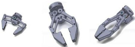
**Figura 5:** Diferentes poses del gripper.
