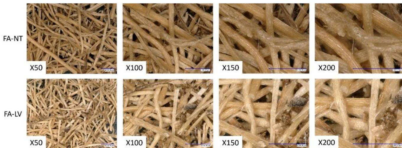
**Figura 11** Micrografías de la fibra de agave nativa y lavada (FA-NT y FA-LV).
