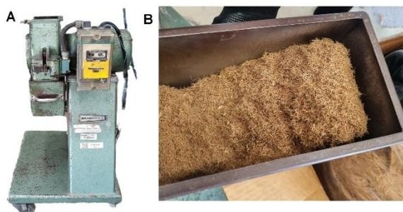
**Figura 1** Trituración de FA: A) Molino de cuchillas marca Brabender® y B) FA molida.
