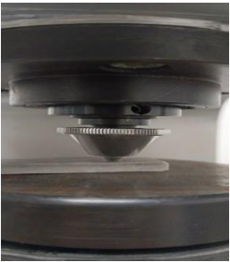
Figura 1: Indentación de dureza Brinell en una probeta de aluminio AA 6061.
