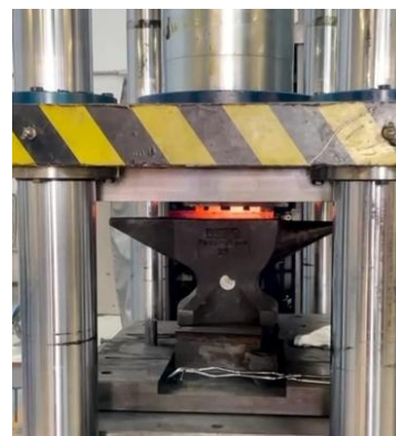
Figura 2: Forja en caliente en la prensa hidráulica FLUIDICA, MODELO: FAC-120.
