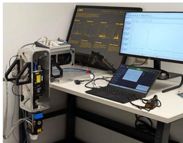
Figura 2: Equipo portátil de LIBS de desarrollo propio para mediciones en fluidos.
