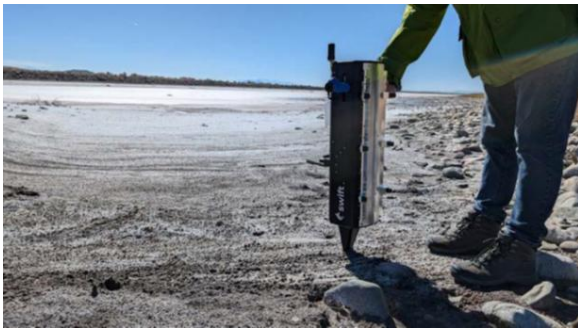
Figura 4: Equipo LIBS portátil realizando mediciones en salares de Utah.
