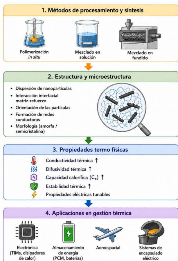
Figura 3. Relación entre métodos de procesamiento, estructura, propiedades termo físicas y aplicaciones de los nanocompuestos poliméricos (elaboración propia).
