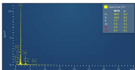
Figura 8. Análisis EDS obtenido del área (b) de la figura 7.
