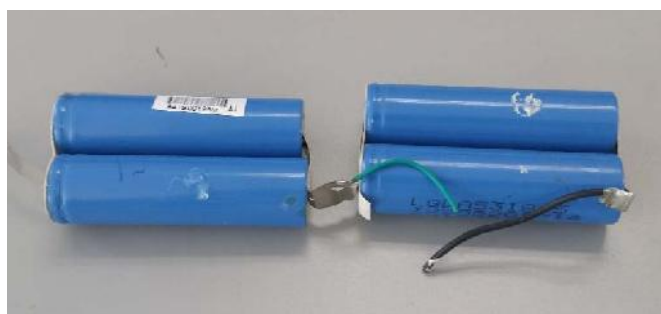
Figura 5. Batería ion-Li desmantelada
