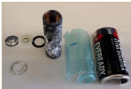
Figura 1. Pila tipo AA desmantelada (carcasa metálica y cubierta plástica)
