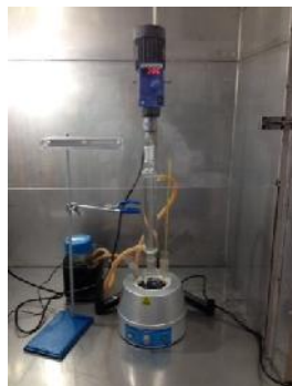
Figura 3. Equipo utilizado para la síntesis de electrocatalizadores por el método del poliol
