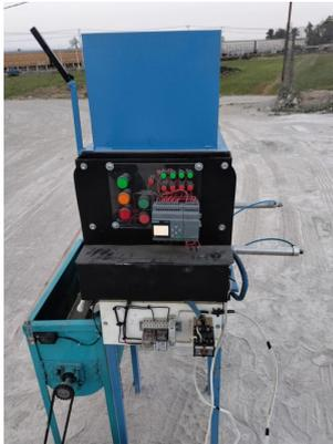
Figura 5: Prototipo de la máquina de dosificación volumétrica y mezclado.
