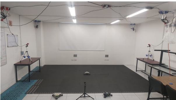
Figura 5: Zona de despliegue del laboratorio LACSCIF con 6 cámaras.
