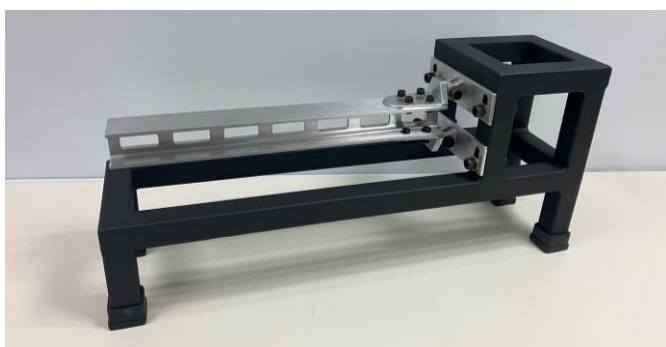
Figura 8: prototipo simple de la unión entre la caja de torsión y semiala.
