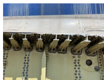
Figura 2: ensamble por orejetas en avión Airbus A320.
