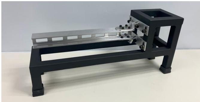
Figura 8: prototipo simple de la unión entre la caja de torsión y semiala.
