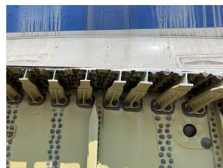
Figura 2: ensamble por orejetas en avión Airbus A320.
