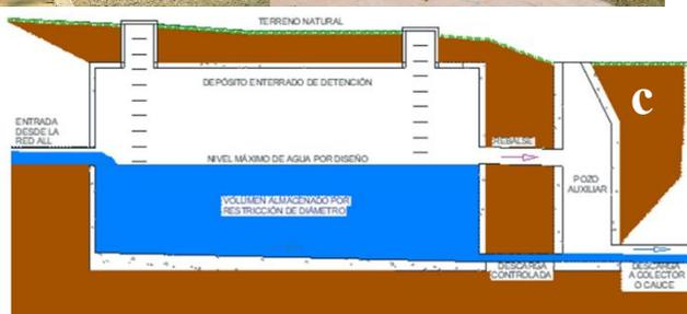
Figura 13: Pavimento permeable en zonas urbanas (a), Pavimento permeable en zonas verdes (b), Diseño esquemático de tanque de detención (c). Fuente: Aguas integrales (2021).
