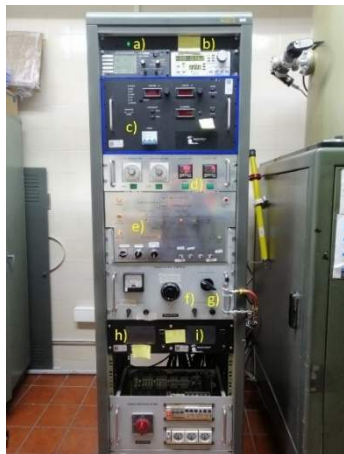
Figura 3: Evaporadora de haz de electrones Balzers, modelo BA510A.
