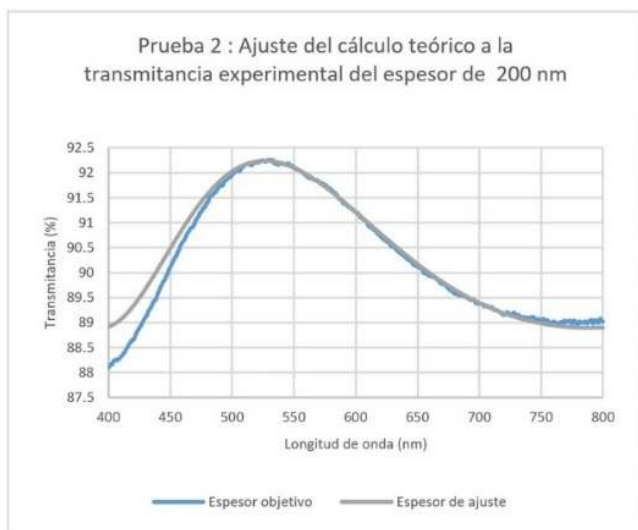
Figura 13: Comparación del cálculo del espesor objetivo de 200 nm con el espesor de ajuste de 270.43 nm.
