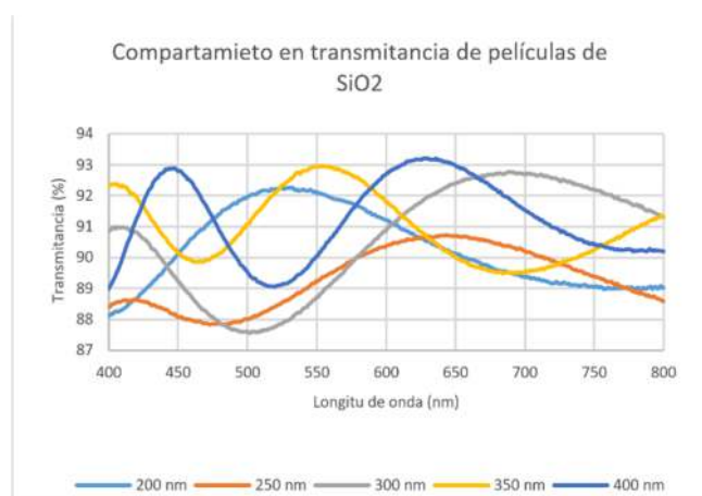
Figura 8: Transmitancia de películas de \text{SiO}_2 de 200 nm, 250 nm, 300 nm, 350 nm, y 400 nm de espesor.
