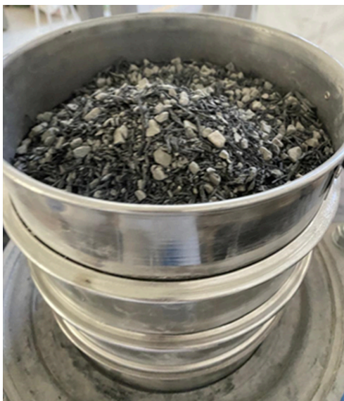
Figura 6: Esquema del material retenido por cada tamiz. Elaboración propia
