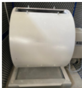
Figura 1: Esquema de la Maquina de los Angeles. Elaboración propia
