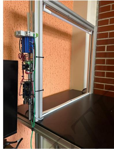
Figura 3: Plataforma experimental de lámpara LED.
