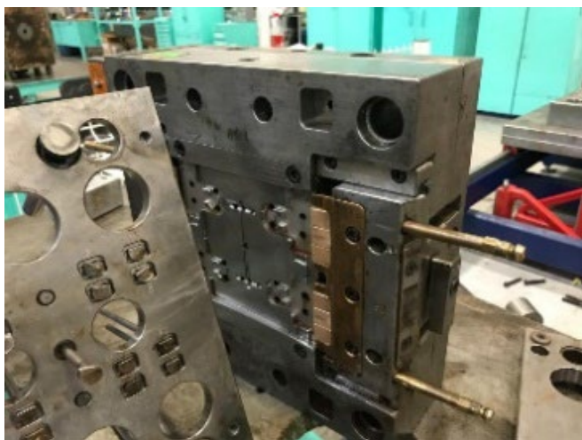
Figura 9: Oxido presente en las cavidades del molde después de 48 semanas sin mantenimiento.
