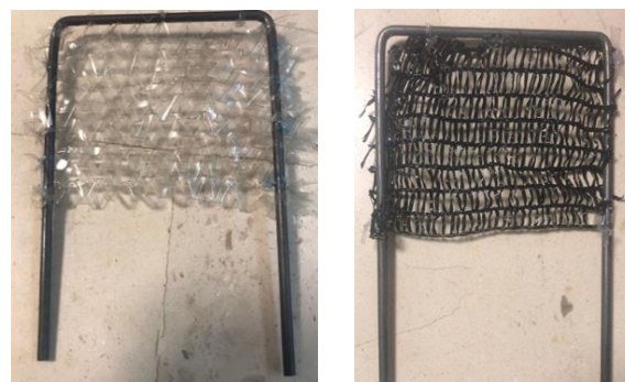
Fig. 3 Probetas cuadradas de malla tejida de plástico PET y malla sombra Raschel 35% sombra para pruebas de eficiencia de recolección en cámara de evaporación-condensación Fuente: elaboración propia.
