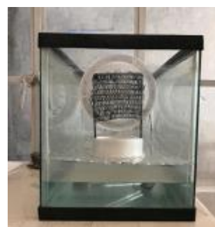
Fig. 4 Montaje de probetas dentro de cámara de evaporación - condensación. Fuente: elaboración propia.
