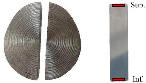
Figura 4. Leva a) corte a la mitad y b) áreas a caracterizar.
