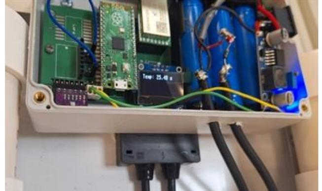
Figura 13: Sistema embebido para transmisión de variables ambientales. Instalación.
