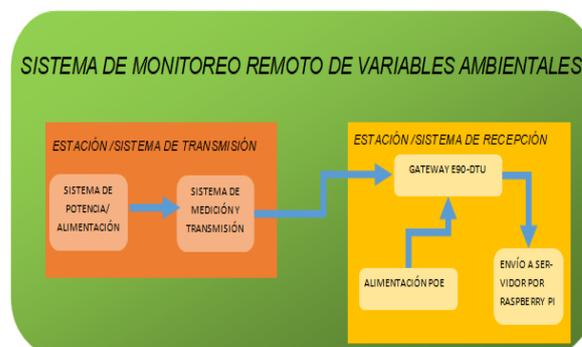
Figura 1: Diagrama a bloques del sistema de monitoreo remoto.
