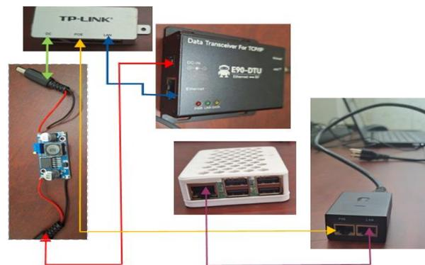
Figura 10: Conexión de dispositivos para implementación del POE.
