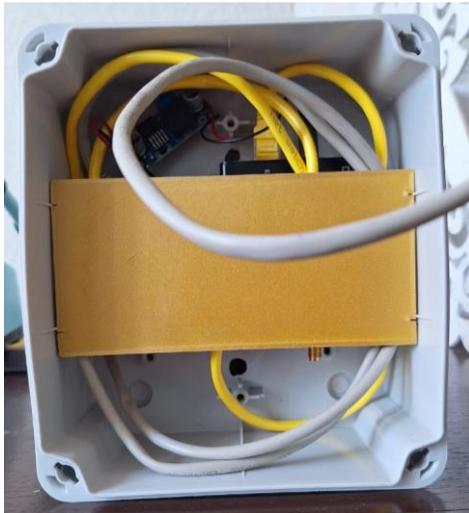
Figura 11: Instalación del Gateway en chasis para exteriores.
