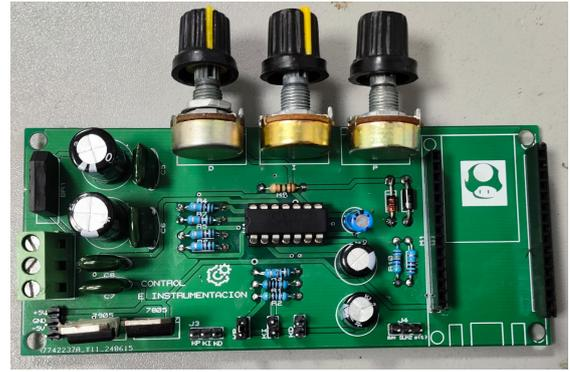
Figura 15: PCB del PID.
