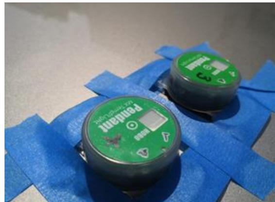
Figura 1: Posición de sensores en toldo de vehículo.
