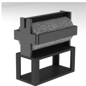
Figura 2: Celda brasileña para ensayo de tracción indirecta.
