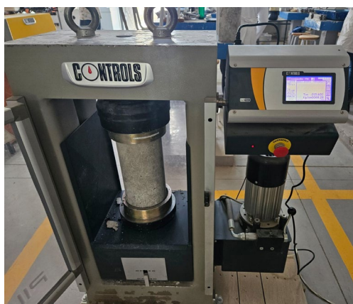
Figura 6: Prueba realizada a los cilindros para determinar la resistencia.
