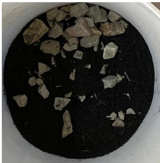
**Figura 1:** Producto de trituración de neumático.
