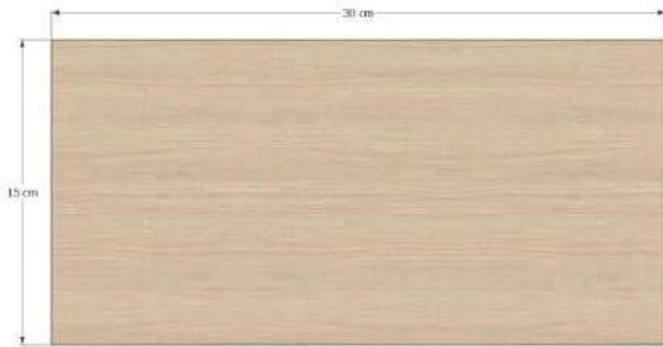
Figura 9. Dimensiones de la sección de la viga.
