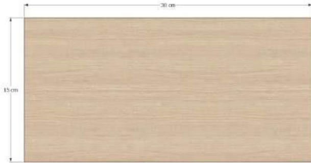
Figura 9. Dimensiones de la sección de la viga.
