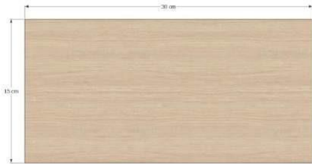
Figura 9. Dimensiones de la sección de la viga.
