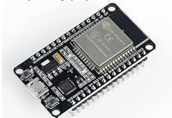
Figura 3: Microcontrolador ESP32 (ESP32 Wi-Fi & Bluetooth SOC | Espressif Systems, s. f.).
